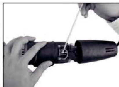
3、使用一字螺丝刀拔开压在碳刷上的弹簧片
