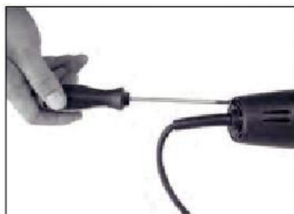
1、使用专用螺丝刀将马达尾部的两颗螺丝拧下
