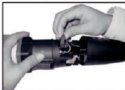
6、取出碳刷，同时依照上述的接线夹方法取出马达反面的另一个碳刷
