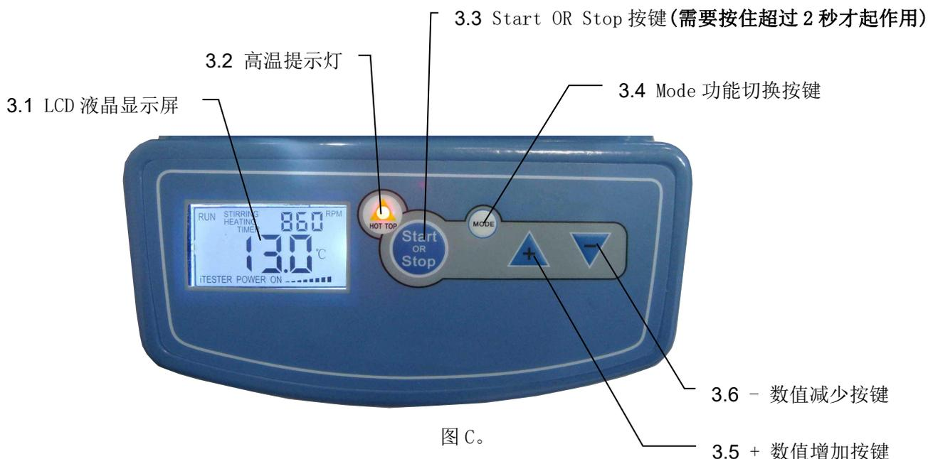
3.1 LCD 液晶显示屏：主要是显示工作状态、执行功能、设定参数和测量值等；
